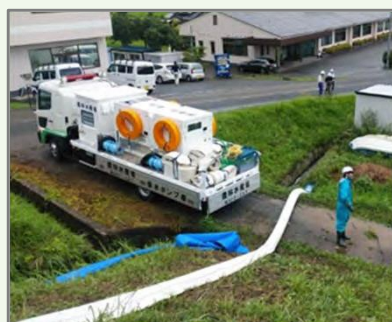
▲排水ポンプ車 による排水 (最大30トン/分 の排水が可能)
